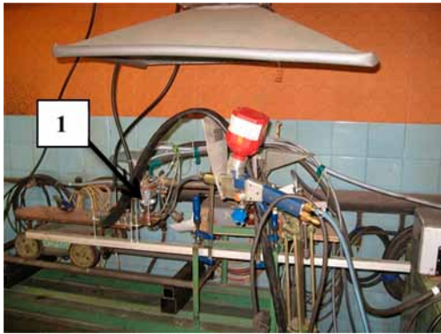
1 pav. Plazminio purškimo stendas: 1 – plazminio purškimo degiklis
