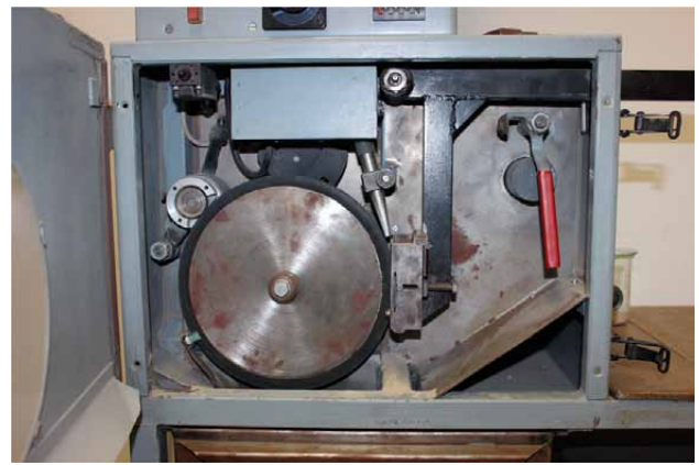
1 pav. Sausosios trinties bandymas pagal ASTM G65
